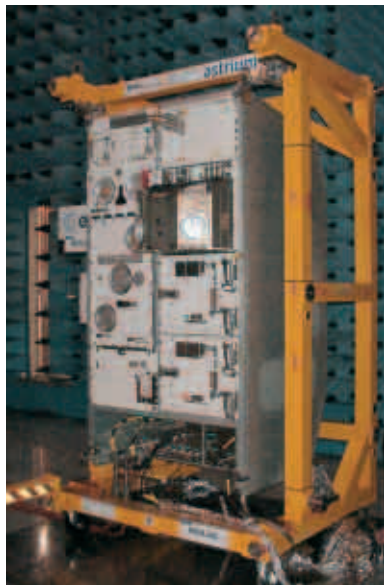
Biolab pendant les essais électromagnétiques
