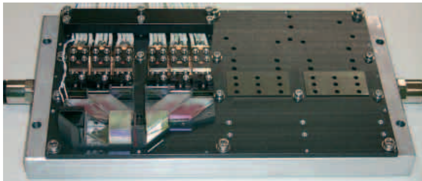
Montage table d'une pompe pour amplificateur laser à haute puissance, alimentée par deux ensembles de six réseaux à diode laser. Les circuits micro optiques et les prismes tournent de façon à réorganiser les faisceaux laser individuels pour optimiser le remplissage de la fibre de sortie.
