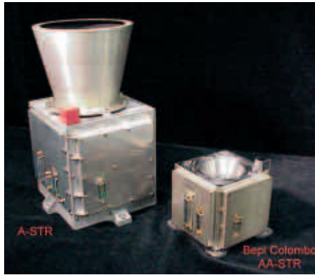
Suiveur stellaire développé pour la mission BepiColombo, comparé à la technologie A-STR actuelle
