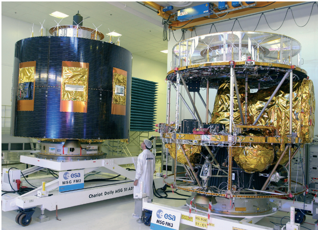
MSG-2 en configuration de vol et MSG-3 sous forme pré-intégrée dans la salle blanche d'Alcatel Space à Cannes (F) (Source : Alcatel Space)
