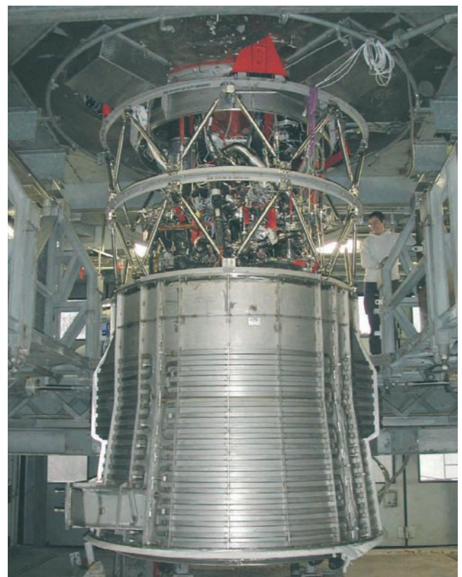
Vulcain-2 dans le simulateur de charge (LSD) du DLR à Lampoldshausen, Allemagne
