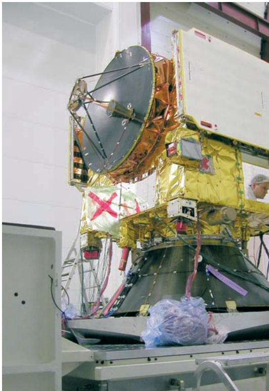
La sonde Venus Express en configuration de lancement pour les essais aux vibrations dans les locaux d'Intespace à Toulouse (F)
