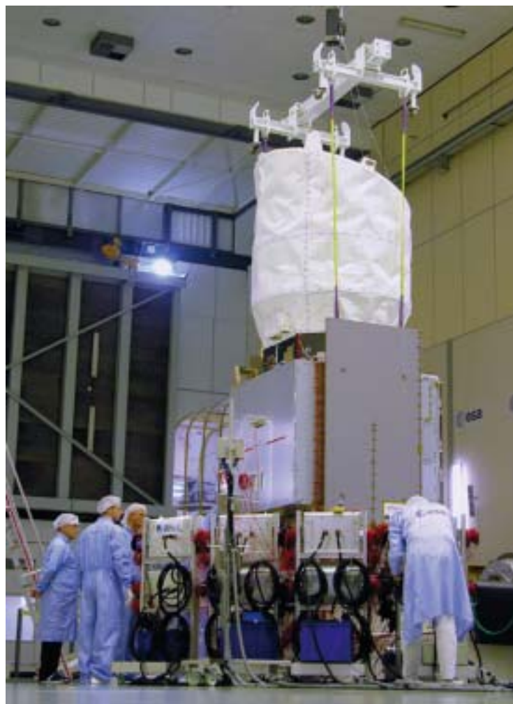
Le modèle structurel d'ADM/Aeolus installé sur la table vibrante du Centre d'essais de l'ESTEC
