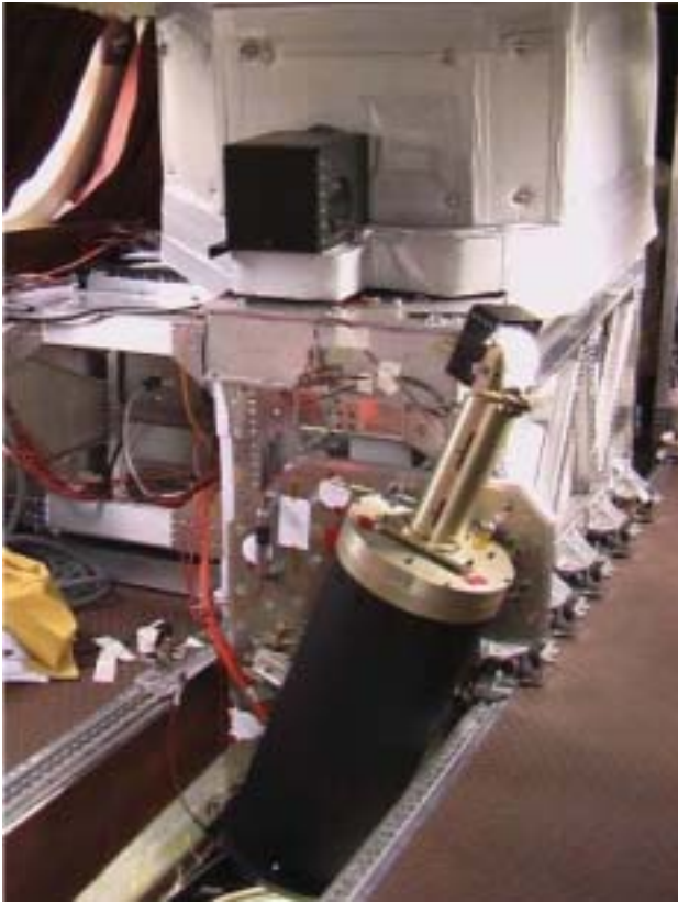
Le démonstrateur aéroporté Aladin installé sur un avion de la DLR lors d'essais en vol
