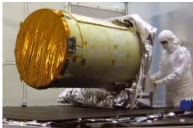
Intégration du déflecteur et du couvercle déployable au modèle de vol de COROT (Source : CSL)
