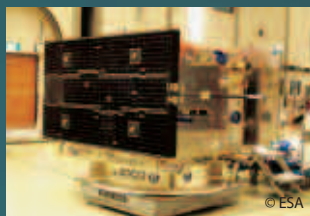
SMART-1 packas ihop till sin hopfällda konfiguration, såsom den kommer att sändas upp.
