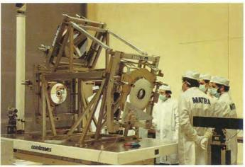
Maquette optique de la charge utile durant les opérations d'alignement (source MATRA, F)
