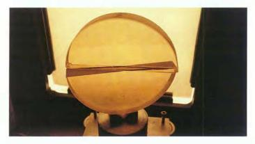
Maquette à échelle réduite du mélangeur de faisceaux (source: REOSC, F)
