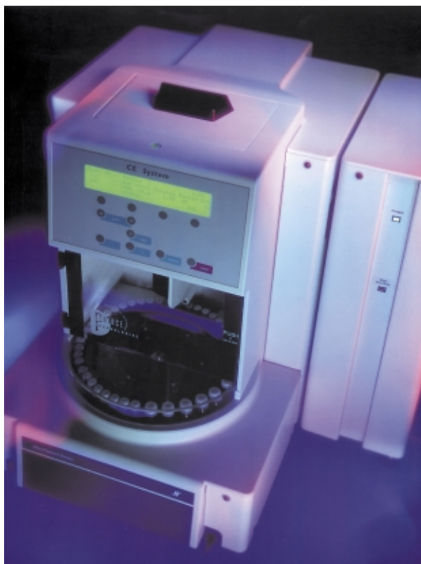
Unité modulaire d'électrophorèse sur colonne capillaire à haute performance
