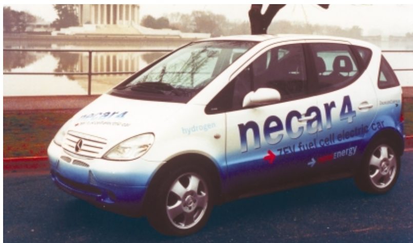
La N-car de Mercedes utilisera une pile à combustible comme source d'énergie
